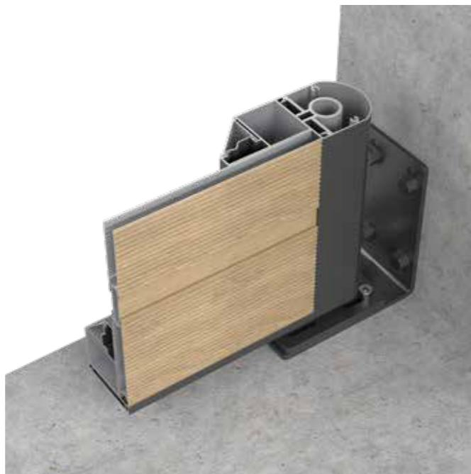
Vues détaillées, supérieure et inférieure, des châssis et profilés rainurés, ainsi que profile de l'axe de pivotement avec INOX 316 GOND qui supporte 250 Kg chacun. Le châssis de portail à un vantail maximum est proche de 4 m<sup>2</sup> et résiste à une charge de vent maximum de 2KPa.
